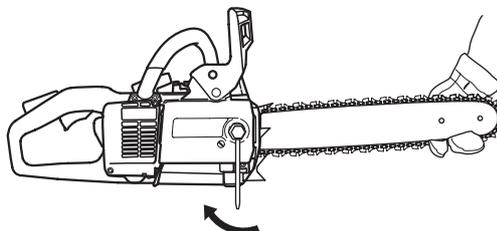
При установке новой цепи следует часто проверять ее натяжение, пока цепь не приработается. Регулярно проверяйте натяжение цепи. Правильно натянутая цепь обеспечивает высокое качество пиления и дольше служит.
