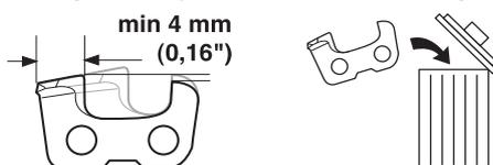
Общие сведения относительно снижения ограничителя глубины врезания.
