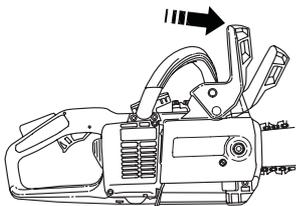
**Зажигание:** Перевести выключатель зажигания в положение включения.
