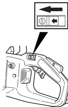
двигатель останавливается, когда контакт остановки будет передвинут в положение остановки.
