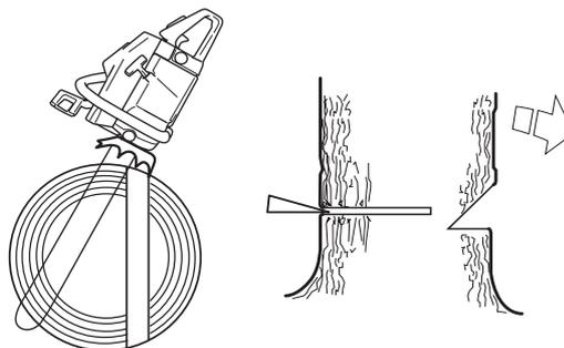
Закончить основной пропил нужно параллельно линии направляющего пропила так, чтобы расстояние между ними составляло около 1/10 диаметра ствола. Нераспиленный участок ствола называется полоса разлома (недопил).
