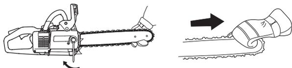
Расположение винта натяжения цепи может быть различным на различных моделях наших моторных пил. См. указания в разделе Что есть что? относительно того, где он расположен на Вашей модели пилы.
