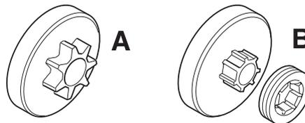
Следует регулярно проверять степень износа звездочки привода. Заменять при сильном износе.
