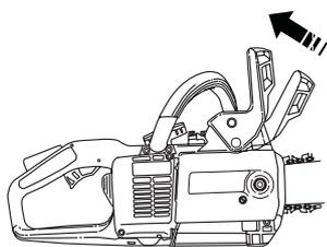
Отвинтите гайки крепления пильного полотна и снимите крышку муфты сцепления (тормоза цепи). Снимите транспортировочное кольцо (А).
