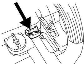
**Топливный насос:** Сожмите несколько раз резиновую грушу топливного насоса пока в нее не начнет поступать топливо. Грушу нет необходимости заполнять полностью.
