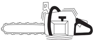
Система виброгашения машины снижает уровень вибрации передаваемый от двигателя или режущего оборудования на рукоятки.
