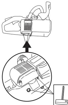
В некоторых глушителях предусмотрен специальный искрогаситель. Если ваша машина оборудована таким глушителем, сетку фильтра следует чистить раз в неделю. Наилучшие пользователи стальной щеткой. Забитая решетка приводит к работе с горячим двигателем, что дает серьезные повреждения двигателя.
