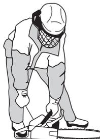
Передвиньте ручку в положение запуска когда в двигателе происходит зажигание и выполните новую попытку запуска. Когда двигатель начнет работать, быстро дайте полные обороты и стартовый газ автоматически выключится.
