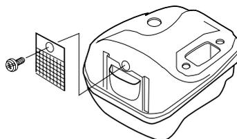
Глушитель служит для снижения уровня шума и отвода раскаленных выхлопных газов от рабочего. Выхлопные газы очень горячие и могут содержать искры, что может привести к пожару при прямом попадании на сухой и воспламеняющийся материал.
